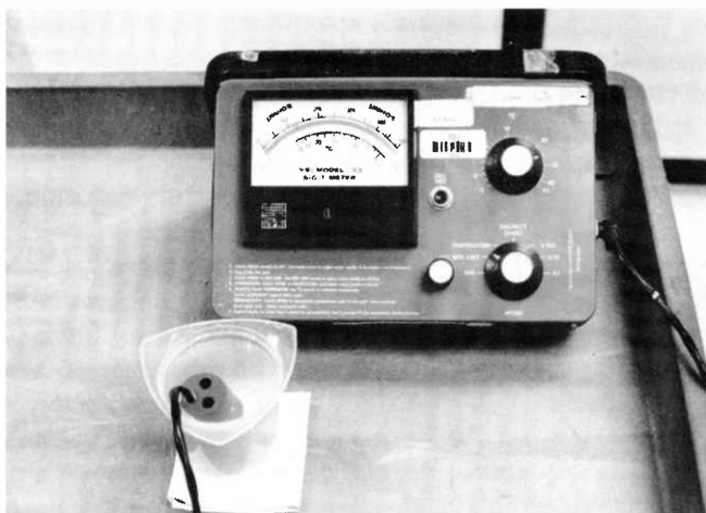
Se usa un medidor de temperatura-pH-conductividad para medir parámetros físicos del agua en el campo.
