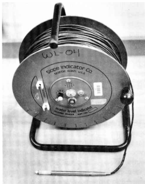
Una sonda eléctrica mide la profundidad al agua.
