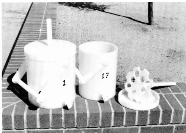
Se usan las partidoras para obtener muestras compuestas de río.
