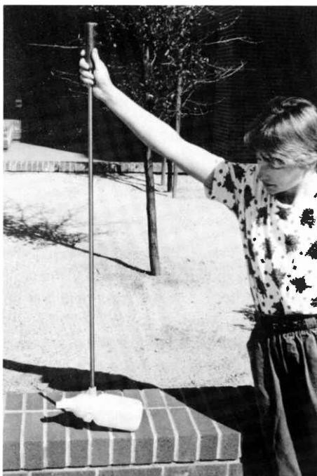
Se puede usar el muestreador de DH-81 para coleccionar muestras compuestas (mostrado aquí con mango de acero).
